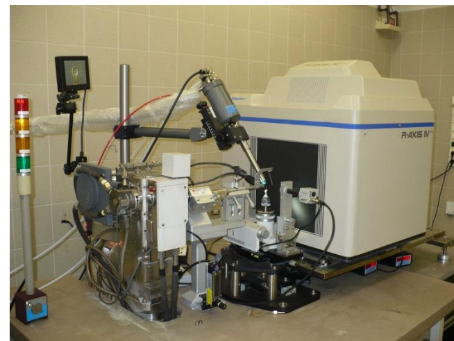
Rigaku R-AXIS IV++ forgóanódos röntgendiffraktométer
