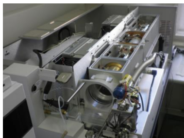
Agilent 6460 hármass kvadrupól MS Semmelweis Egyetem, Gyógyszerészeti Intézet
