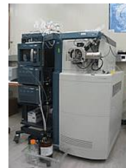
Waters Q-TOF Premier MS, MTA TTK, MS Proteomika Kutatócsoport
